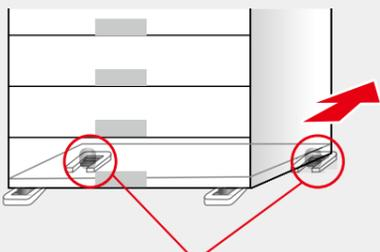
後方2カ所のエコ・ストッパーが働くので耐荷重は約200kg
